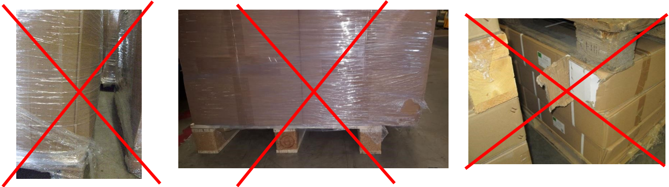
Abbildung 4: Nicht akzeptiert – Ausbeulen/Ausbauchen und generell Überstand / Aufplatzen
